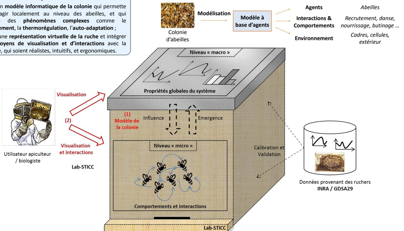
Modèle à base d'agents de la colonie, simulée dans une ruche virtuelle en 3D, pour permettre sa visualisation et des interactions locales avec l'utilisateur. Les propriétés globales de la colonie émergent des comportements et interactions entre abeilles dans la ruche. L'INRA et le GDSA29 fournissent les données provenant de leurs ruches pour calibrer et valider le modèle.
